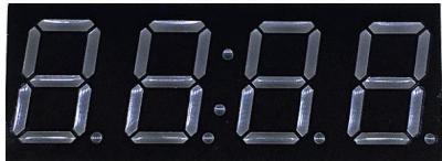
共阳数码管是指将所有发光二极管的阳极接到一起，形成公共阳极（COM）的数码管，共阳数码管在应用的时候，应该将 COM 端口接到正极，当某一段发光二极管的阴极为低电平的时候，相对应的段就点亮，当某一字段的阴极为高电平的时候，相对应段就不亮。
